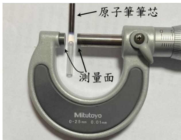
(ii) 將筆芯置於兩測量面之間，輕輕旋轉粗調螺旋筒使兩測量面接觸筆芯之兩側(如下圖)，接下來旋轉微調螺旋筒直到發生彈簧聲響為止。(注意：此時不可再使用粗調旋筒調整測量面之位置，以免造成測量之誤差)。
